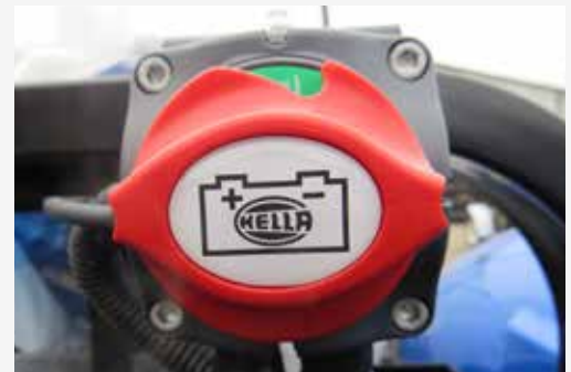
Desconector electrónico de batería. Cuenta con corta corriente.
